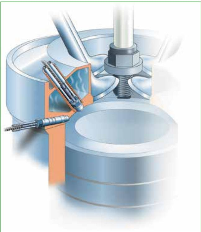
Sensoranwendung für Verbrennungsdrucküberwachung
