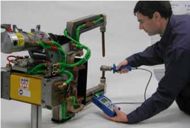
Anwendung Messgerät Widerstandsschweißung
